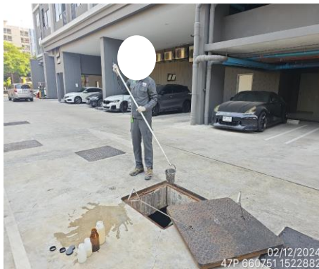
บริเวณก่อนเข้าสู่ระบบบำบัดน้ำเสีย บ่อเกรอะ ชุดที่ 1
